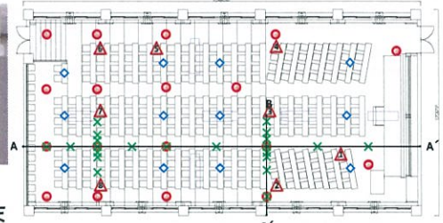
○天井扇 ×鉛直温度 ◇机上温度 △温熱快適性指標 図2 天井扇の位置と各測定項目の測定点
